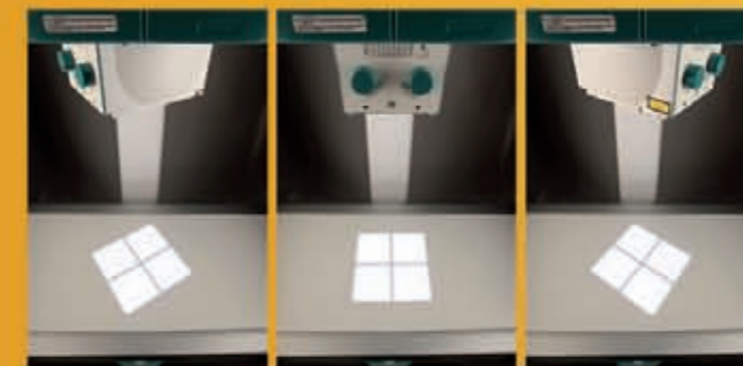
Opción de rotación del colimador, favorece la exploración evitando volver a posicionar al animal.
